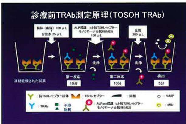
固相化されたTSHレセプターを封入した凍結乾燥された試薬があります。この試薬に患者の血清を加えます。そうすると患者の血清中のTRAbがTSHレセプターに結合します。10分間インキュベーションの後、洗浄工程で干渉物質を洗い流します。次に、アルカリ性ホスファターゼを標識したヒト抗TSHレセプターモノクローナル抗体であるM22を加えますと、患者のTRAbが結合していないTSHレセプターに結合します。ここでまた10分間インキュベーションし
